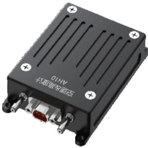
AH10 是一款专门为测量大气压力以及空速而设计的模块，内置高精度差压式空速传感器以及气压传感器，精度可达  $\pm 0.25\%$  FSS BFLS，同时测量大气压力以及动静差压。
