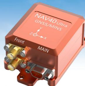
NAV40Ultra( 双天线 ) 内部集成三轴陀螺仪，三轴加速度计，三轴磁场计，GNSS 接收模块，气压高度计等微型传感器，通过内置改进型扩展卡尔曼滤波算法（EKF）进行信息融合，有效降低载体机动，振动以及环境温度和电磁干扰影响，为用户提供高达 200Hz 的完整，可靠的三维位置，三轴姿态，三轴速度，三轴加速度等信息。
