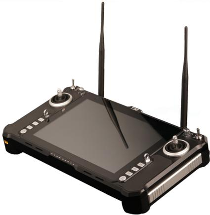
T30 是一款集成工业级电脑系统和一体化链路遥控系统的单兵手持地面站。采用三频合一链路同时完成影像传输，飞机的遥控遥测功能，独创可编程双 SBUS 更灵活控制吊仓或转台。主控电脑采用 X86 架构的 17 高性能处理器，可满足大多数飞机对地面站的功能运算需求，还支持视频解算本地识别。系统可自主安装 Linux 或者 Windows，现有应用软件无需再次开发可以直接安装运行。T30 手持地面站在行业里通用易用，是便携性的无人设备控制终端。
