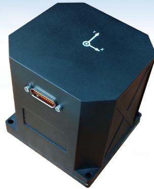
NAV800 光纤惯性组合导航装置采用纯捷联方案，主要由 3 只 40 型光纤陀螺、3 只石英挠性加速度计、导航处理电路（含卫星导航模块）组成，能够实现惯性 / 卫星组合导航，具有精度高、环境适应性好、可靠性高等特点。
