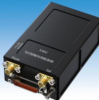
S30U 飞行控制与导航系统适用于小型电动常规固定翼、垂直起降固定翼、多旋翼等布局飞行器，其内部集成飞行控制计算机和高精度、高动态微组合导航系统（BD/GPS/MINS，内置国产卫导板卡，支持 BD2/BD3 优先），重量 ≤ 100g。支持 RTK 高精度定位和双天线高精度测向，可以实现一键自动起飞、降落、悬停、盘旋、返航、定高、开伞以及多种形式的按预定航线自主巡航功能。支持巡飞弹末制导、集群组网编队，支持固定目标和移动目标攻击。内嵌数字飞机模型，使仿真飞行更为简便。
