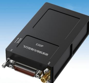
S30P 巡飞弹专用飞行控制与导航系统适用于微型及小型电动常规固定翼、垂直起降固定翼、多旋翼等布局的飞行器，其内部集成飞行控制计算机和高精度、高动态微组合导航系统 (GPS/MINS)，重量仅为 90g。支持巡飞弹末制导、组网编队，支持大过载（最大 100g）发射，支持固定目标和移动目标攻击。内嵌数字飞机模型，使仿真飞行更为简便。
