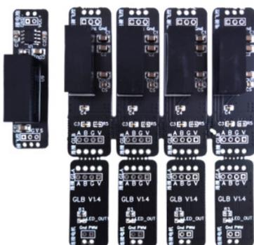
PWM 隔离模块由 GLA 模块（PWM 输入端）和 GLB 模块（PWM 输出端）组成，GLA 模块与 GLB 间通过隔离 RS422 差分信号传输 PWM 信息，完成电气隔离。RS422 差分信号传输距离长、抗干扰能力强，能够有效减小旋翼电机大电流工作时，通过地线串入飞控的干扰。
