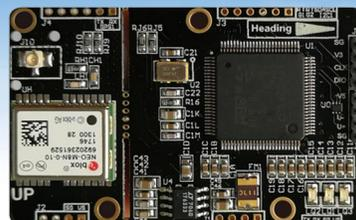
NAV30 Pro (OEM 型) 内部集成三轴陀螺仪, 三轴加速度计, 三轴磁场计, GNSS 接收模块, 气压高度计等微型传感器, 通过内置改进型扩展卡尔曼滤波算法 (EKF) 进行信息融合, 有效降低载体机动, 振动以及环境温度 and 电磁干扰影响, 为用户提供高达 200Hz 的完整, 可靠的三维位置, 三轴姿态, 三轴速度, 三轴加速度等信息。NAV30 PRO (OEM 型) 结构上分为 GPS 模块和惯性测量模块两个部分, 可以整板安装, 也可以层叠使用, 还可以分开单独使用 (惯性测量模块可以完成无 GPS 情况下的所有功能), 便于用户进行系统集成。
