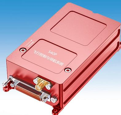
S40P 飞行控制与导航系统适用于电动或油动小型常规固定翼、垂直起降固定翼、多旋翼等布局飞行器，其内部集成飞行控制计算机和高精度、高动态微组合导航系统（GPS/MINS），可以实现一键自动起飞、降落、悬停、盘旋、返航、定高、开伞以及多种形式的按预定航线自主巡航功能。支持巡飞弹末制导、组网编队，支持大过载（最大 100g）发射，支持固定目标和移动目标攻击。内嵌数字飞机模型，使仿真飞行更为简便。
