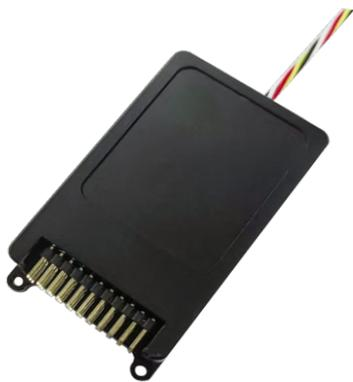
RE10 接口扩展模块是一款用于扩展飞控接口数量的设备,可满足用户对更多串口、PWM 接口、RPM 接口的需求。方便用户连接更多的设备和使用更多的控制信号,提高系统的灵活性和功能性。
