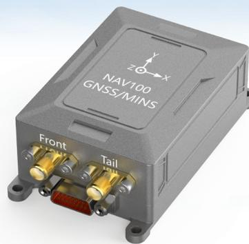
NAV100 组合导航系统内置高性能的 MEMS 惯性测量单元与全系统全频高精度定位定向模组，输出载体的姿态、航向、位置、速度等信息；在 GNSS 无效时，可持续输出惯性解算的位置、速度和航姿信息，短时间内具备一定的导航精度保持功能。该产品可靠性高，环境适应性强。
