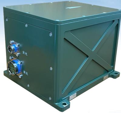
NAV900 光纤惯性组合导航主要由三轴一体 70 型光纤陀螺、3 只石英挠性加速度计、导航处理电路（含卫星导航模块）组成，能够实现惯性 / 卫星组合导航、惯性 / 里程组合导航、惯性 / DVL 组合导航，具有精度高、体积小、重量轻、可靠性高等特点，专为高精度无人装备研制。
