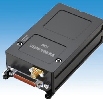
S60N 飞行控制与导航系统适用于中小型常规固定翼、垂直起降固定翼布局的飞行器。其内部集成飞行控制计算机和三余度微组合导航系统（GPS/MINS），可以实现固定及移动平台一键自动起飞、降落、悬停、盘旋、返航、定高、开伞以及多种形式的按预定航线自主巡航功能，支持编队飞行，具有多种编队队形，完善的编队保护措施等特点，内含数字飞机模型，使仿真飞行更为简便。
