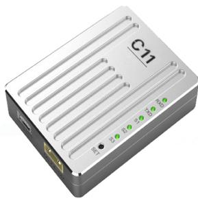
C11 微型数传电台是一款超小体积、超轻量化无人系统专用频段工业级高性能无线串口通信模块，支持网络、点对点、点对多点的通信模式。C11 工作频率为 840~900MHz，采用跳频技术（FHSS）实现可靠的无线异步数据传输。最大发射功率 1W，最大传输波特率可达 500kbps，最大传输距离可达 60Km。特别适合于微型无人机的遥控遥测数据链。
