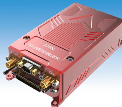
S70N 飞行控制与导航系统，其内部集成多冗余高精度组合导航系统（动态姿态精度 0.1°）、高精度差分定位模块和双天线定向模块（航向精度 0.1°/2m 基线），具有高集成度、高精准确度、多冗余、尺寸小、重量轻、支持用户深度定制等特点。S70N 适用于各种全自主起降功能要求的常规固定翼、垂直起降固定翼、多旋翼等无人机。
