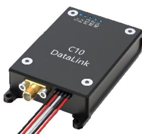
C10 微型数传电台是一款无人系统专用频段工业级高性能无线串口通信模块，支持网络、点对点、点对多点的通信模式。工作频率为 840~900MHz，采用跳频技术 (FHSS) 实现可靠的无线异步数据传输。最大发射功率 1W，最大传输波特率可达 345kbps，最大传输距离可达 60Km。特别适合于各类中小型无人机的遥控遥测数据链。
