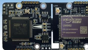
NAV30 Ultra( 双天线 OEM 型 ) 内部集成三轴陀螺仪，三轴加速度计，三轴磁场计，GNSS 接收模块，气压高度计等微型传感器，通过内置改进型扩展卡尔曼滤波算法（EKF）进行信息融合，有效降低载体机动，振动以及环境温度和电磁干扰影响，为用户提供高达 200Hz 的完整，可靠的三维位置，三轴姿态，三轴速度，三轴加速度等信息。NAV30 Ultra( 双天线 OEM 型 ) 结构上分为 GNSS 模块和惯性测量模块两个部分，可以整板安装，也可以层叠使用，还可以分开单独使用（惯性测量模块可以完成无 GNSS 情况下的所有功能），便于用户进行系统集成。
