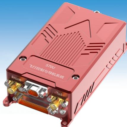
S70U 飞行控制与导航系统，其内部集成多冗余高精度组合导航系统（动态姿态精度 0.1°）、高精度差分定位模块和双天线定向模块（航向精度 0.1°/2m 基线），具有高集成度、高精度、多冗余、尺寸小、重量轻、支持用户深度定制等特点。S70U 适用于各种全自主起降功能要求的常规固定翼、垂直起降固定翼、多旋翼、直升机等布局飞行器。
