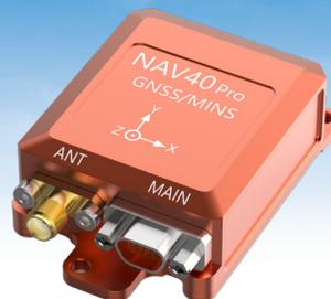
NAV40Pro 内部集成三轴陀螺仪，三轴加速度计，三轴磁场计，GNSS 接收模块，气压高度计等微型传感器，通过内置改进型扩展卡尔曼滤波算法（EKF）进行信息融合，有效降低载体机动，振动以及环境温度和电磁干扰影响，为用户提供高达 200Hz 的完整，可靠的三维位置，三轴姿态，三轴速度，三轴加速度等信息。
